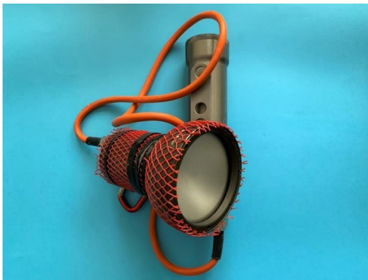
Foto 9 - Illuminatore per ripresa (ad ampio raggio) con canister esterno) (autore A.Eusebio)
