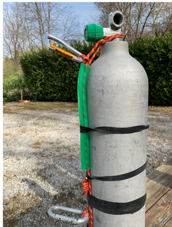
Foto 27 – Imbrago di bombola laterale da 7 litri con moschettoni speleo per l'uso in acque fredde
