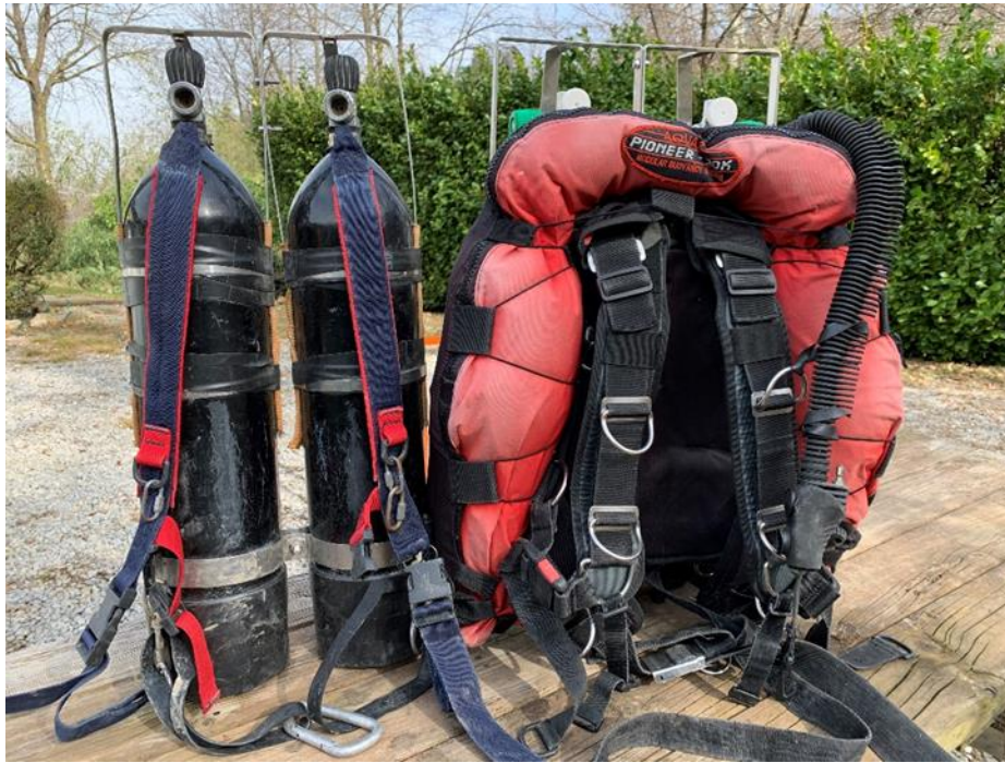
Foto 26 - Due bibo 7+7 e 10+10 con le evidenti protezioni delle rubinetterie
