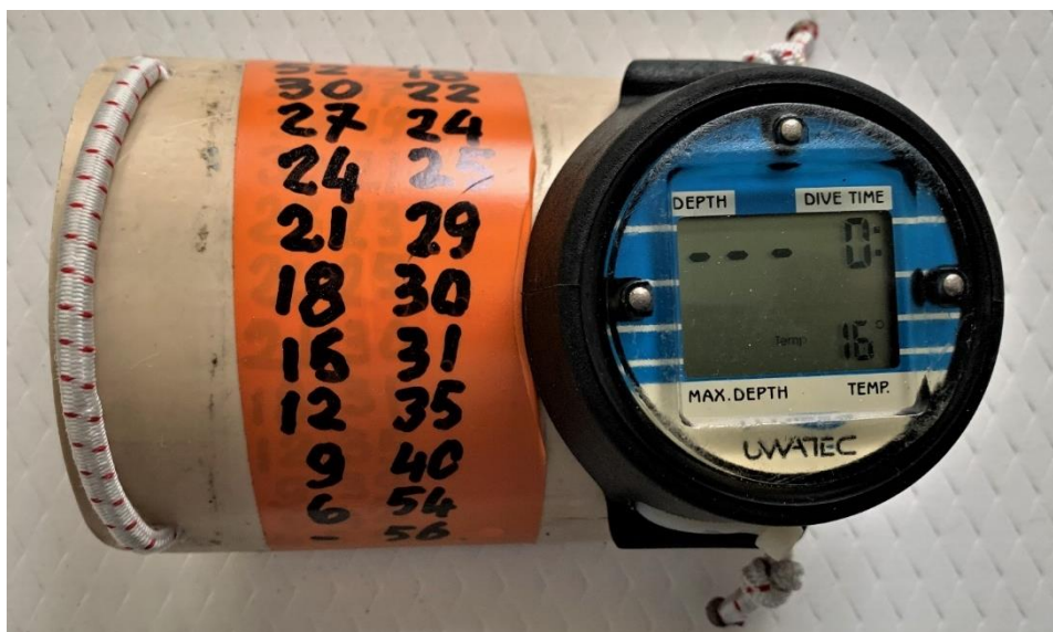
Foto 21 - Tabella decompressiva riportata su lavagnetta con bottom timer
