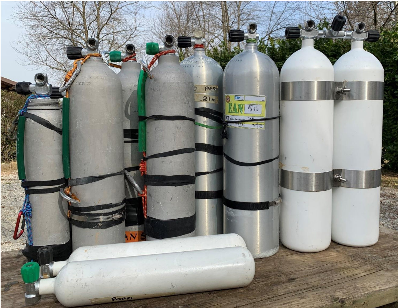
Foto 25 - Bombole subacquee di varia capacità e bibombola assemblato con fascioni inox
