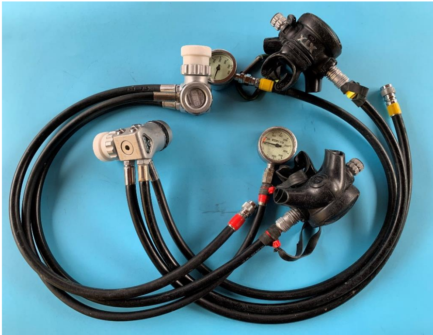
Foto 18- Due gruppi erogatori completi con fruste corte e nastrati
